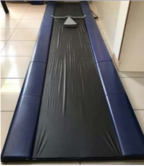
Resim 1. Baropedometre ölçüm cihazı yürüyüş platformu
